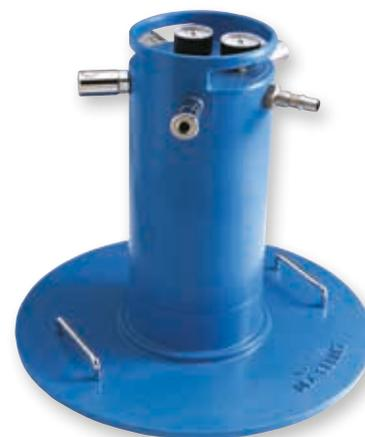
Dès perception d'une odeur d'huile dans l'air respiré ou lorsque la différence de pression entre l'aval et l'amont des filtres est de plus de 1 bar, il est nécessaire de changer le jeu de filtres du Distributeur Epurateur.
